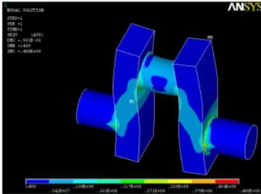
Figure 29. Von-Mises stress
